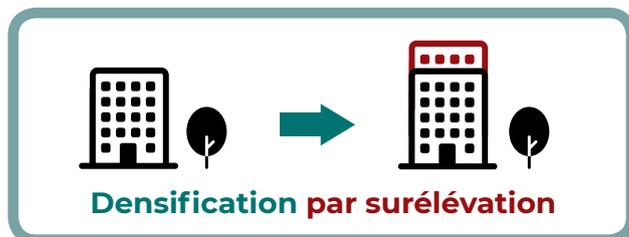
La notion de surélévation comporte 3 éléments : une construction en dur, une prolongation verticale des façades, et un rehaussement du faitage de la toiture du bâtiment.
